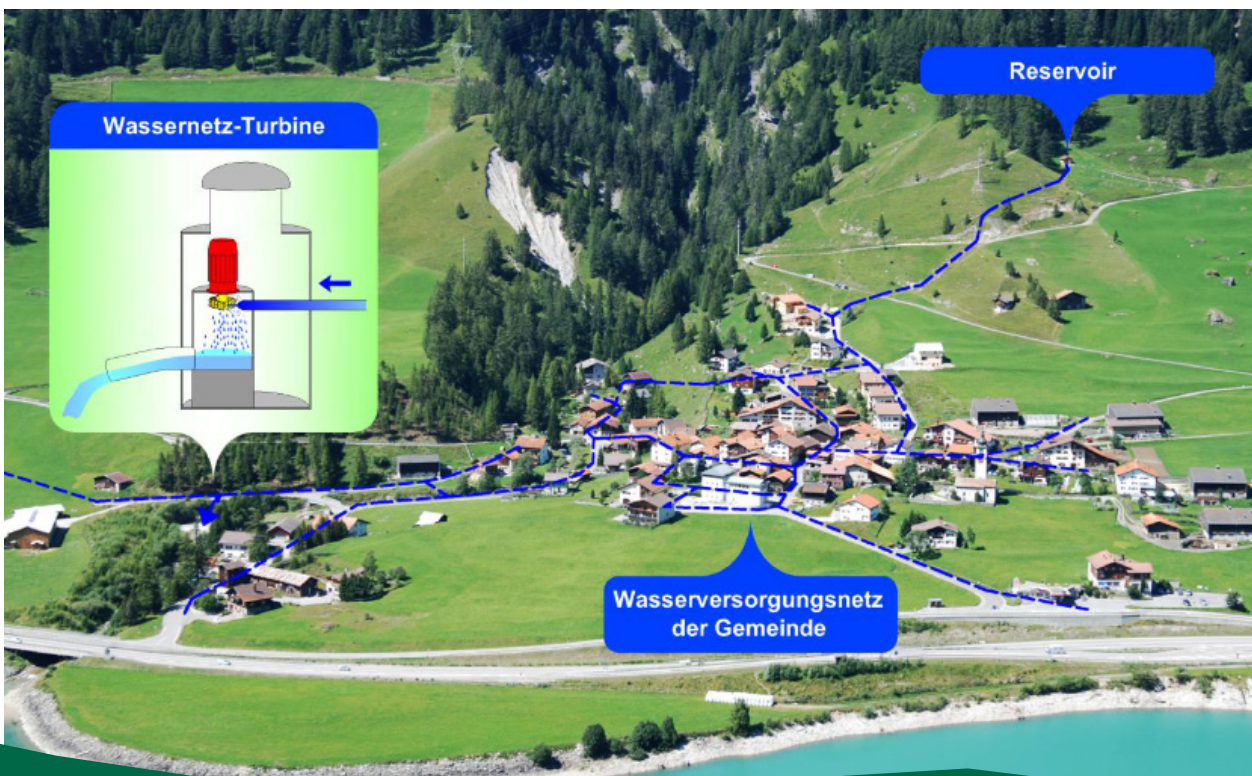
Abb. 12 Verteilungsnetz Trinkwasser der Gemeinde Sufers mit Standort der Wassernetz-Turbine (Quelle: Ensy AG)
